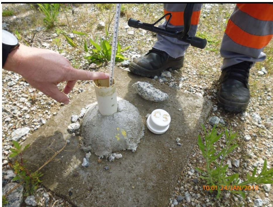
Foto 7 – Leitura do piezômetro Casagrande PZ-05 na crista da barragem de enrocamento com núcleo argiloso.
